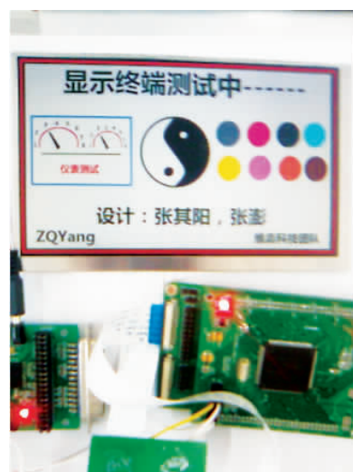
图 4 由所设计的控制器驱动的 TFT-LCD 显示照片 Fig. 4 Picture of TFT-LCD controlled by TFT-LCD controller
